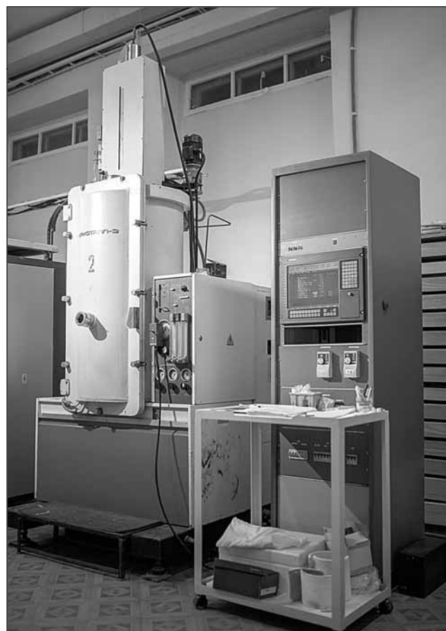
Установка «Кристалл-2» для выращивания монокристаллов методом Чохральского
