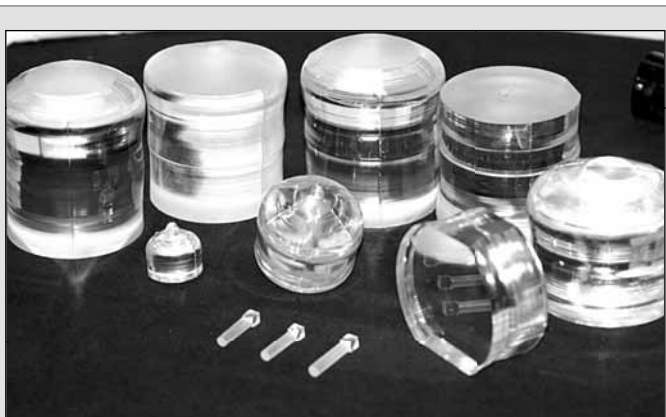
Монокристаллы ниобата и танталата лития, выращенные в Лаборатории материалов электронной техники
