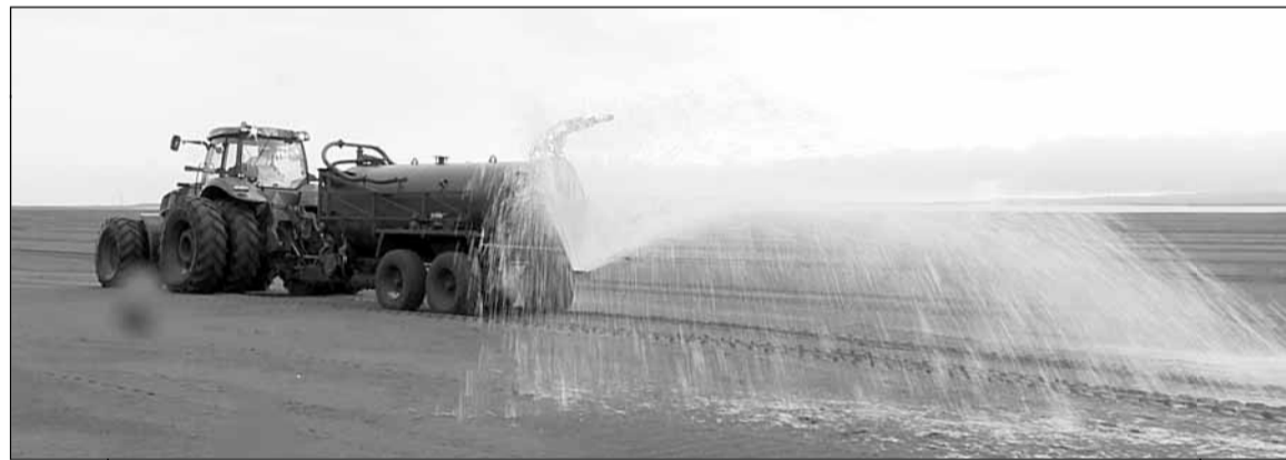
Непосредственно полив «хвостов». Кстати, реагент и по цвету, и по запаху абсолютно напоминает клей ПВА
